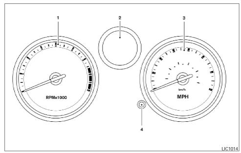
LIC1015 SPEEDOMETER AND ODOMETER
